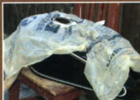
Fóliával védjük a fényezett tankot a fröccsenő folyadéktól
