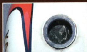
A Fertan rozsdoldó szürkére színezte a Yamaha-tankot
