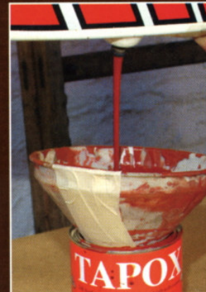
A maradék fölösleges Tapox a második kezeléshez felhasználható
