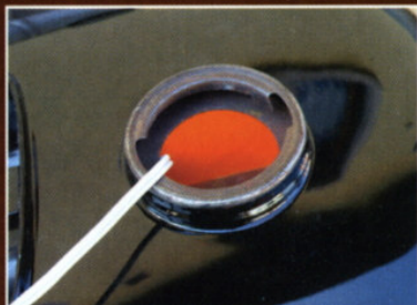
BMW R51/3: ezt a tankot már a gyárban sem védték megfelelően
