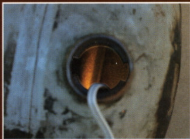
A Quickly-tank: egyenletes rozsdás és olajgyantás lerakódás
