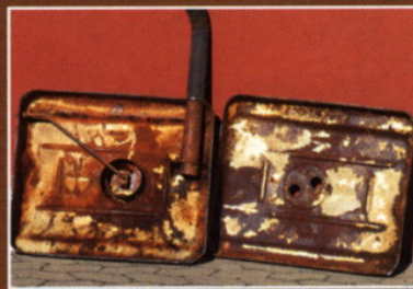
Metszet: az Adenauer-Mercedes szétmárt tankja
