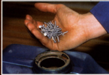
Kavics helyett csavarokkal: nem marad vissza por
