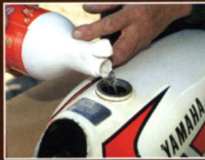
A motortisztító eltávolítja a kétütemű üzemanyagának olaját, és zsirtalanít
